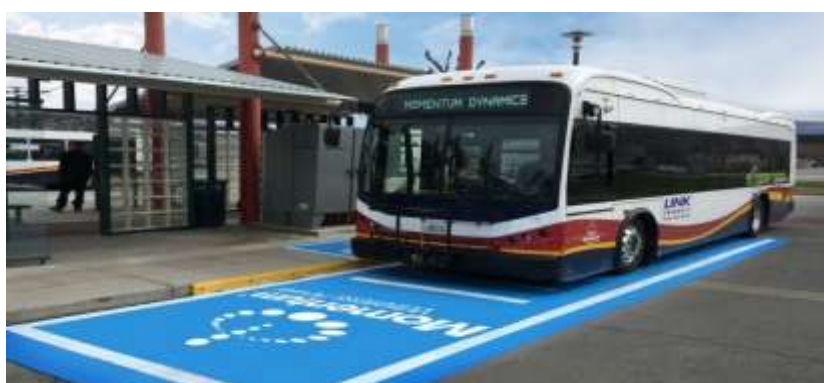
Рис.4. Беспроводная зарядка для электробусов мощностью 200 кВт в США.
