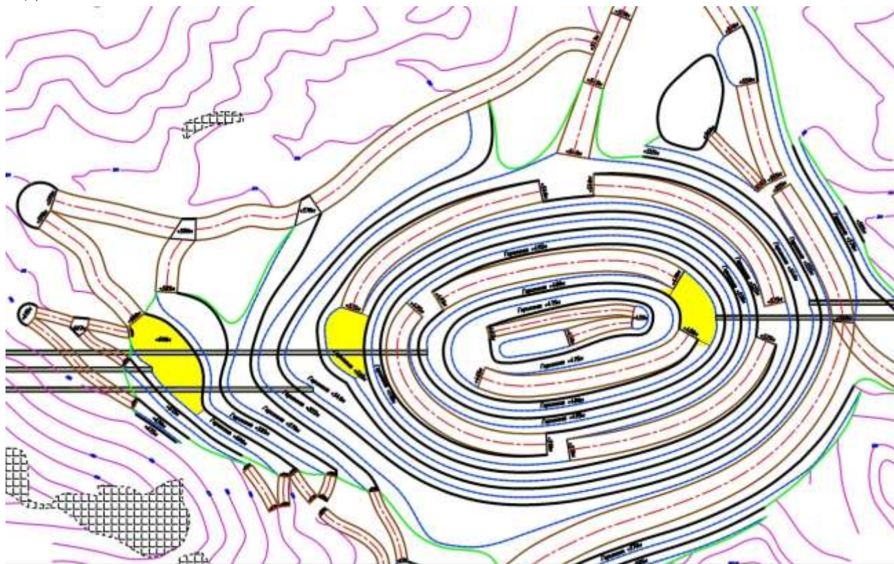
Рисунок. 1 Финальная форма карьера по отработке рудного тела №51 Зиаэтинского рудного поля с учетом размещения на бортах карьера специальных площадей под промплощадки перспективных штольневых горизонтов.
