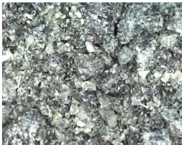
3-rasm. Tebinbuloq titan magnetitini laboratoriya tadqiqoti.
