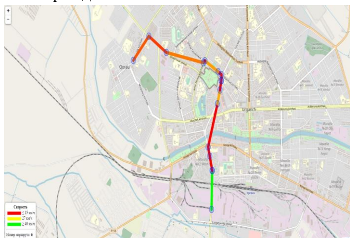
3-расм. 6-йўналишдаги автобуснинг тезликларни ўлгариши
