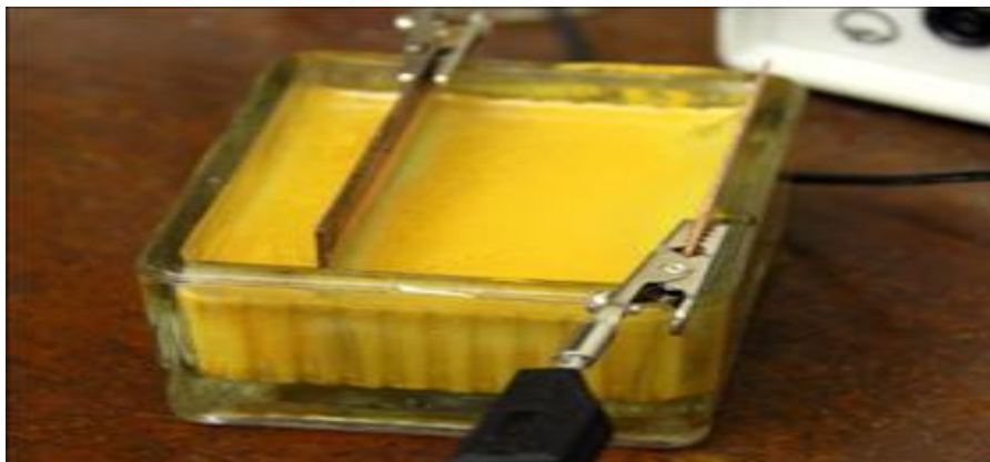
22-rasm- Osh tuzi (NaCl) elektrolizi. Fotosuratda elektroliz faol bo'lganligi aniq ko'rsatilgan. Sariq rang Cl xlor ionlarining mavjudligi bilan bog'liq.
